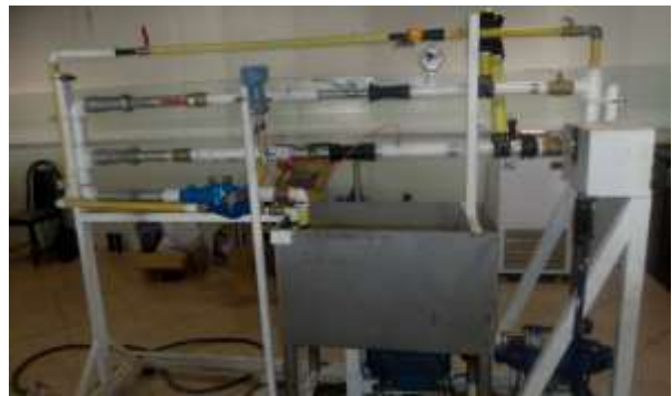
شکل ۲. شمایی از مدل آزمایشگاهی جهت اندازه‌گیری افت فشار موضعی شیرخودکار
