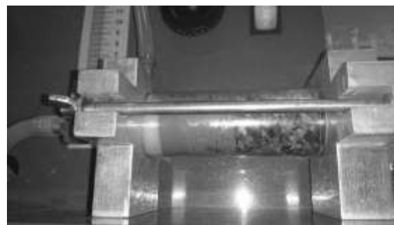
شکل ۵. عدم شستگی خاک واگرا با ۰/۴٪ نانورس در هد ۵۰ میلی‌متر
