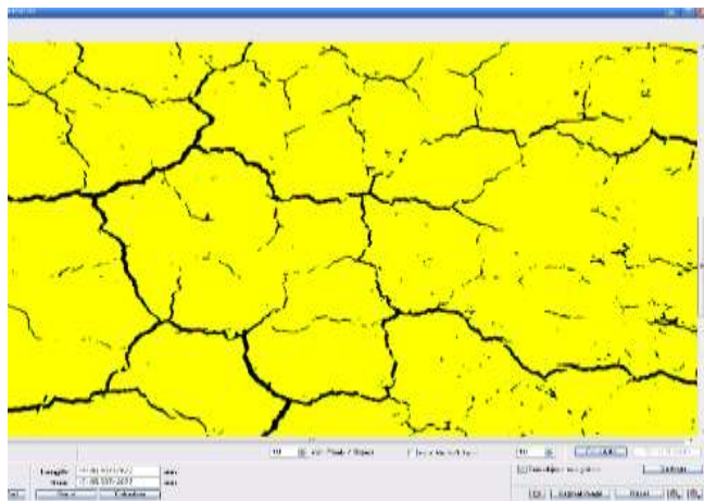
شکل ۱. آنالیز تصویر سطح خاک رسی توسط نرم‌افزار GSA Image Analyser
