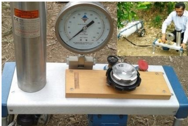
شکل ۲. اندازه‌گیری پتانسیل آب گیاه بوسیله دستگاه اتافک فشار
