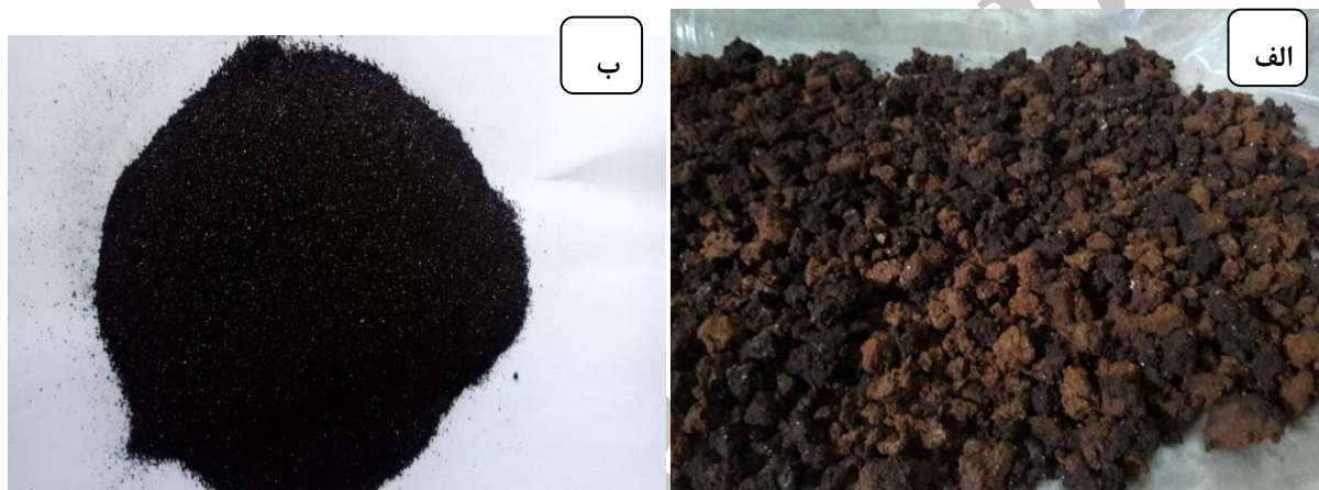
شکل ۱. تصویر ماده خام لجن فاضلاب صنعتی هواخشک قبل (الف) و بعد از تبدیل به زغال زیستی (ب)
