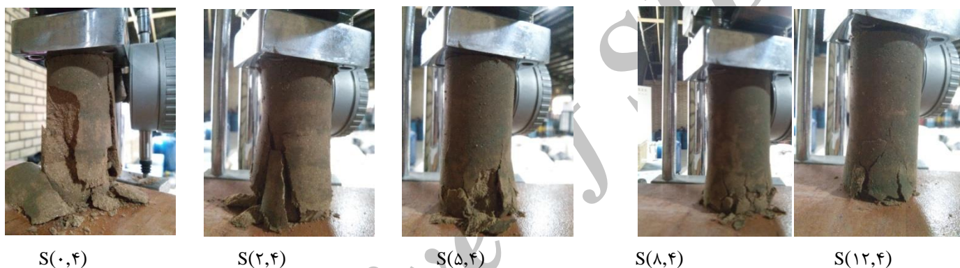
شکل ۱۰. تصویر نمونه‌های با ۴ درصد آهک و درصد‌های مختلف خاکستر باگاس پس از گسیختگی در زمان عمل آوری ۲۸ روزه
