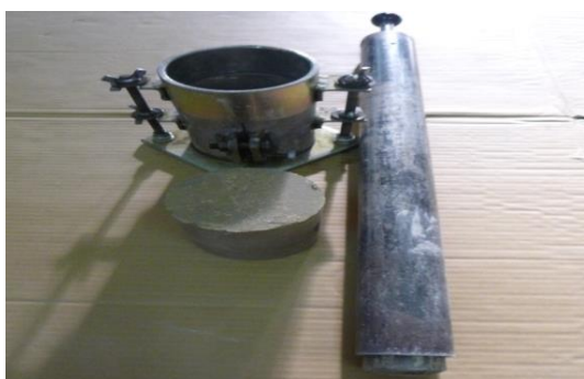
شکل ۳- مولد، چکش و نمونه متراکم شده
