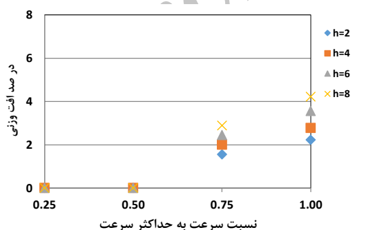
شکل ۱۸- درصد افت وزنی نمونهها در ۳۰٪ سیمان، \Theta=30^\circ
