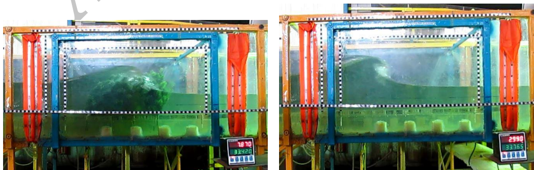
شکل ۶- نمایی از پروفیل عرضی موج شکننا در حالت با و بدون پوشش
