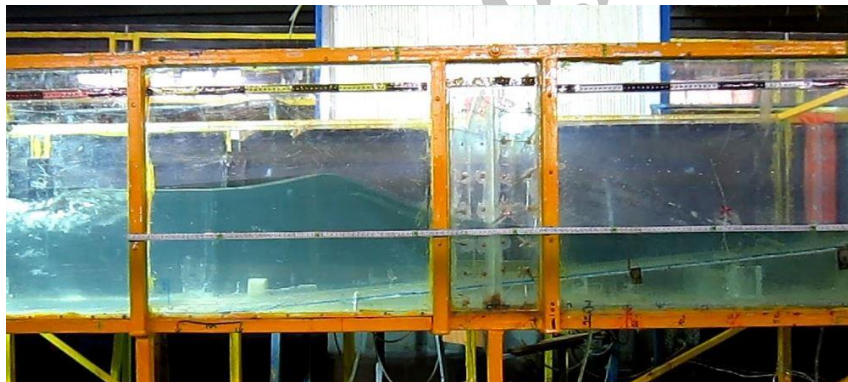
شکل ۵- نمایی از لحظه بالاروی موج منفرد از ساحل شیبدار
