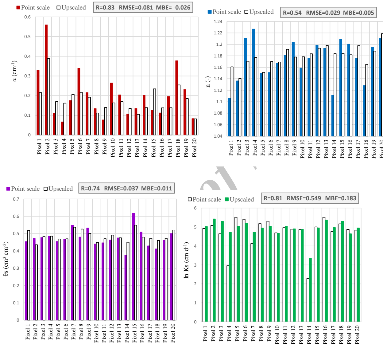
شکل ۲. مقادیر پارامترهای هیدرولیکی مشاهده‌ای (اندازه‌گیری شده) در مقیاس نقطه‌ای و فرامقیاس (1 km) با استفاده از روش PAO به ازای ۲۰ پیکسل انتخابی
