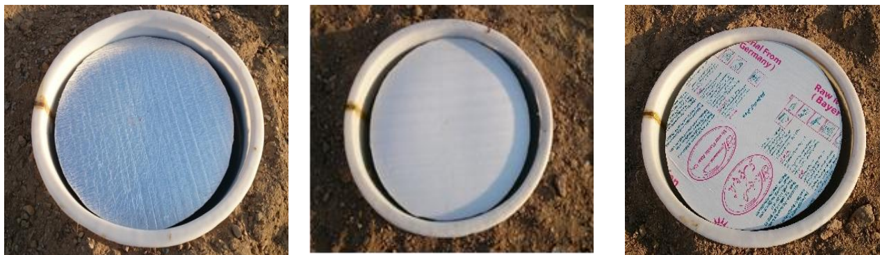
شکل ۱- پوشش‌های شناور به ترتیب از راست به چپ پلی‌کربنات، پلی‌استایرن و پلی‌استایرن با روکش آلومینیوم
