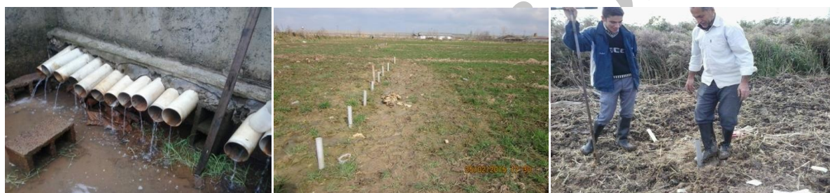
شکل ۳. اندازه‌گیری دبی خروجی زهکش به روش حجمی و سطح ایستابی با استفاده از چاهک
