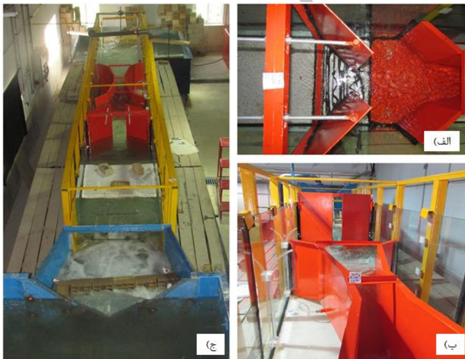
شکل ۲. تصاویری از (الف) فلوم آزمایشگاهی، (ب) دریچه سالونی و (ج) پارشال فلوم
