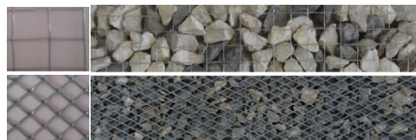
شکل ۵. توری‌های مورد استفاده در ساخت آبشکن توری سنگی
