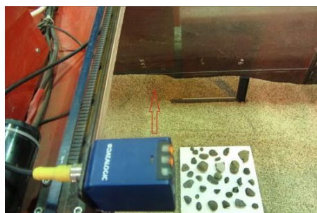
شکل ۴- نمایی از دستگاه لیزر اسکنر و نحوه حرکت آن برای برداشت توپوگرافی بستر سنگ‌دانه‌ای (پیکان)
