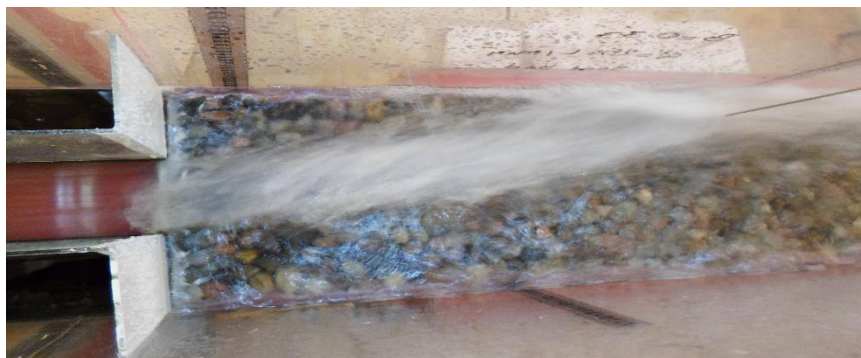
شکل ۳- پرش هیدرولیکی نامتقارن در مقطع واگرایی زیر
