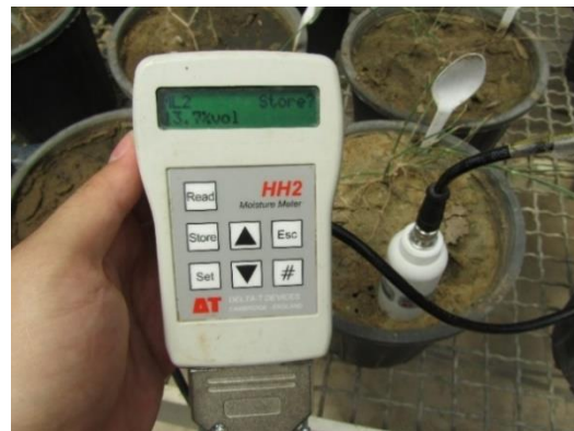
شکل ۱. نحوه کار با دستگاه صفحات فشاری (سمت راست) و نحوه قرائت رطوبت با دستگاه TDR (سمت چپ)
