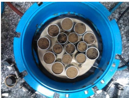
شکل ۱. نحوه کار با دستگاه صفحات فشاری (سمت راست) و نحوه قرائت رطوبت با دستگاه TDR (سمت چپ)
