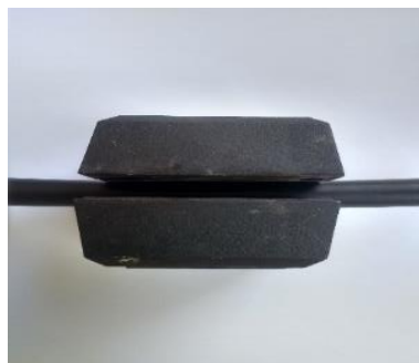
شکل ۲- تصویری از جفت آهنرباهای دائمی تثبیت شده بر روی لوله مابین آنها، جهت مغناطیسی شدن محلول غذایی درون لوله
