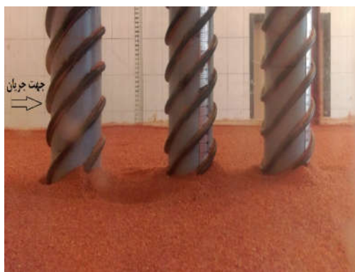
شکل ۳- شماتیک پایه مسلح‌شده
