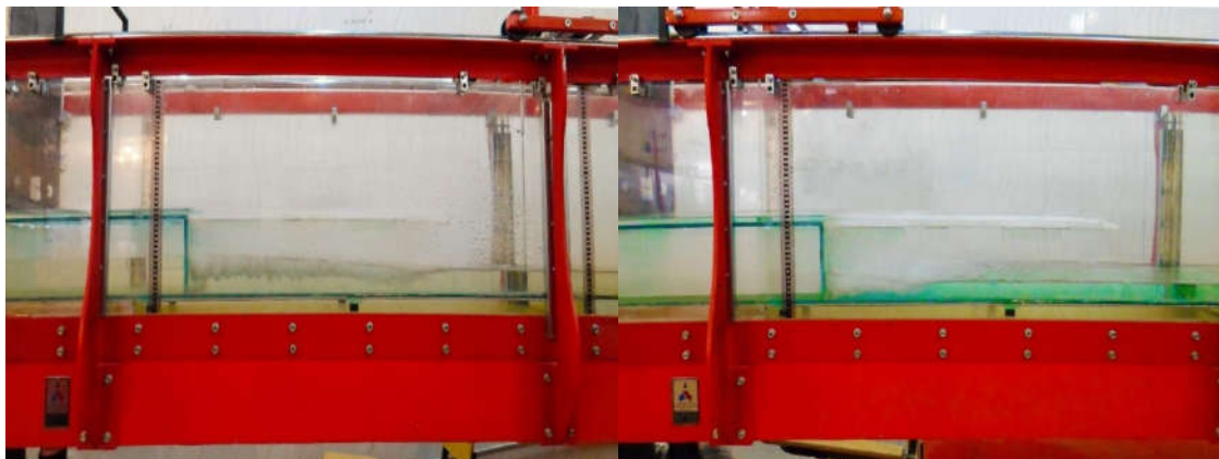
شکل ۲. شرایط مختلف ایجاد تلاطم در شیب‌شکن‌های قائم مجهز به صفحه مشبک افقی با جریان فوق بحرانی در بالادست
