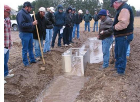
شکل ۱- تصاویری از فلوم‌های استوانه‌ای مورد استفاده در کانال‌های دایره‌ای و دوزنقه‌ای در شرایط آزمایشگاهی و میدانی (Samani, 2017)
