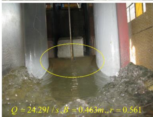
شکل ۷- تغییرات نیمرخ عرضی سطح آب و عدد فرود جریان در گلوگاه به ازای شرایط مختلف آزمایشگاهی
