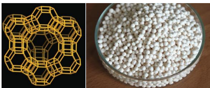
شکل ۲- زئولیت دانه‌بندی شده و نمای شماتیک از ساختمان یک نوع زئولیت
