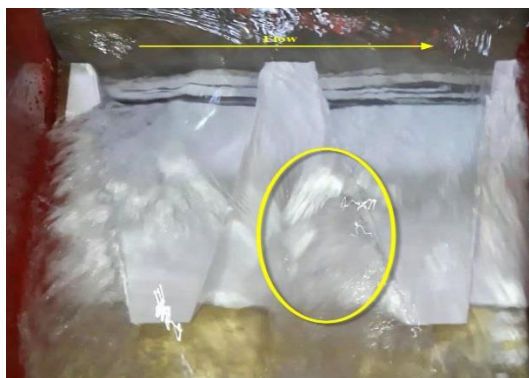
شکل ۱۰ - نمونه‌ای از پیچیدگی جریان در تیغه سمت چپ سیکل وسط سرریزهای پایه ۱۰ سانتی‌متری
