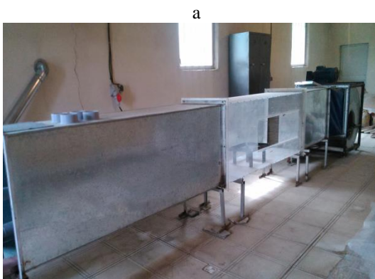
شکل ۲- (a) تونل باد، (b) اندازه گیری فرسایش پذیری بادی به عنوان شیب خط رابطه بین شدت فرسایش بادی و سرعت باد
