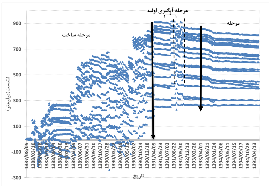
شکل ۳- نشست قائم سد ایوشان نسبت به زمان در سه مرحله ساخت، اولین آبیگری و بهره‌برداری (ابزار IS229)
