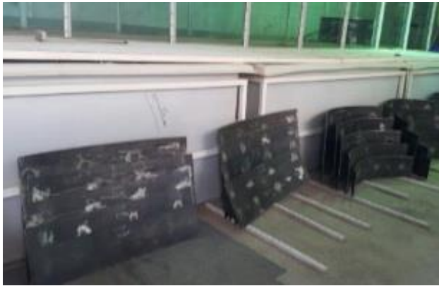
شکل ۵. تعدادی از سرریزهای لبه تیز دایره‌ای، قبل از نصب در فلوم.
