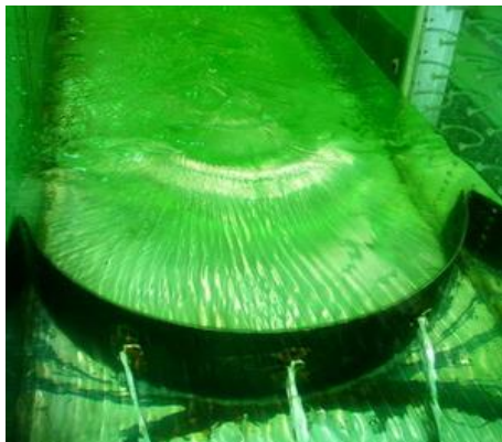
شکل ۲. سرریز لبه تیز دایره‌ای هم عرض کانال و قوس به سمت بالادست. تصویر از نمای بالادست و در جهت جریان گرفته شده است.
