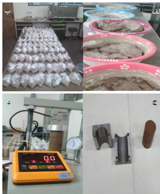
شکل ۲. تهیه نسبت‌های اختلاط خاک و آب نمک (الف) و تهیه نسبت‌های اختلاط خاک شور با ماسه بادی (ب) نمونه متراکم شده و قالب تراکم (ج) و آزمایش مقاومت فشاری تک محوری (د)
