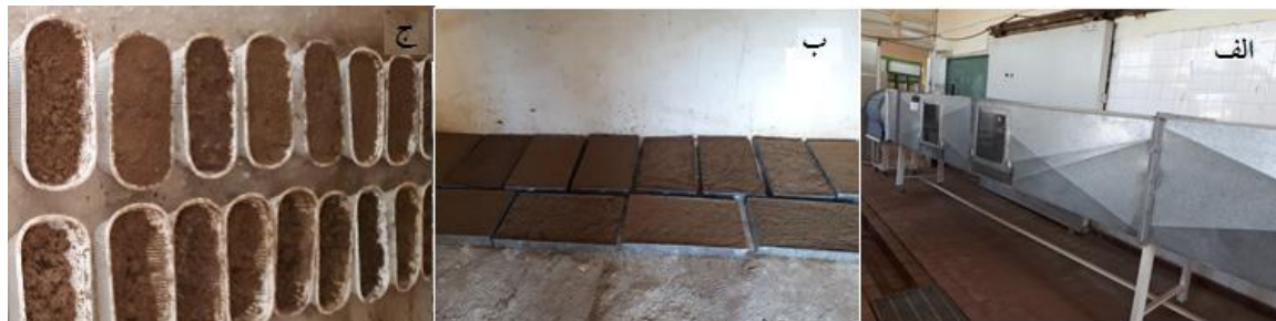
شکل ۱- نمایی از دستگاه تونل باد مورد استفاده (الف)، سینی‌های حاوی خاک پس از اعمال تیمارها (ب)، ظروف پلاستیکی با ابعاد ۵۰ × ۱۳۰ × ۲۲۰ میلی‌متر حاوی خاک پس از اعمال تیمارها (ج).
