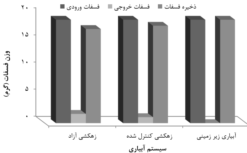
شکل ۱۱- بیلان فسفات در تیمارهای زهکشی آزاد، کنترل شده و آبیاری زیرزمینی در طول یازده مرحله آبیاری
