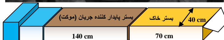
شکل ۱- تصویر فلوم مورد استفاده (بالا) و شماتیک فلوم (پایین)
