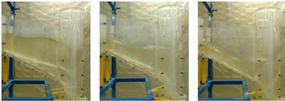
شکل ۴- نمای جانبی جریان در سازه ورودی برای دبی (الف) ۱۹/۴ L/s (ب) \beta=0/251 (ج) \beta=0/571
