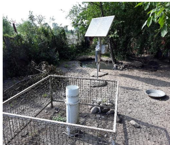
شکل ۱۲- ایستگاه تخیرسنجی فاقد مشخصات و عدم رعایت حریم
