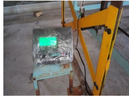
شکل ۶- محل قرارگیری لودسل و نشانگر آن در کنار قسمت لبه چاقویی
