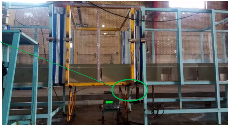
شکل ۲- نمای قسمت لبه چاقویی و اتصال آن به بالادست و پائین‌دست فلوم
