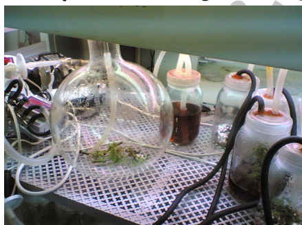
شکل ۵- سیستم غرقاب موقت استفاده شده برای ریزازدیادی Rosa damascena Mill.
