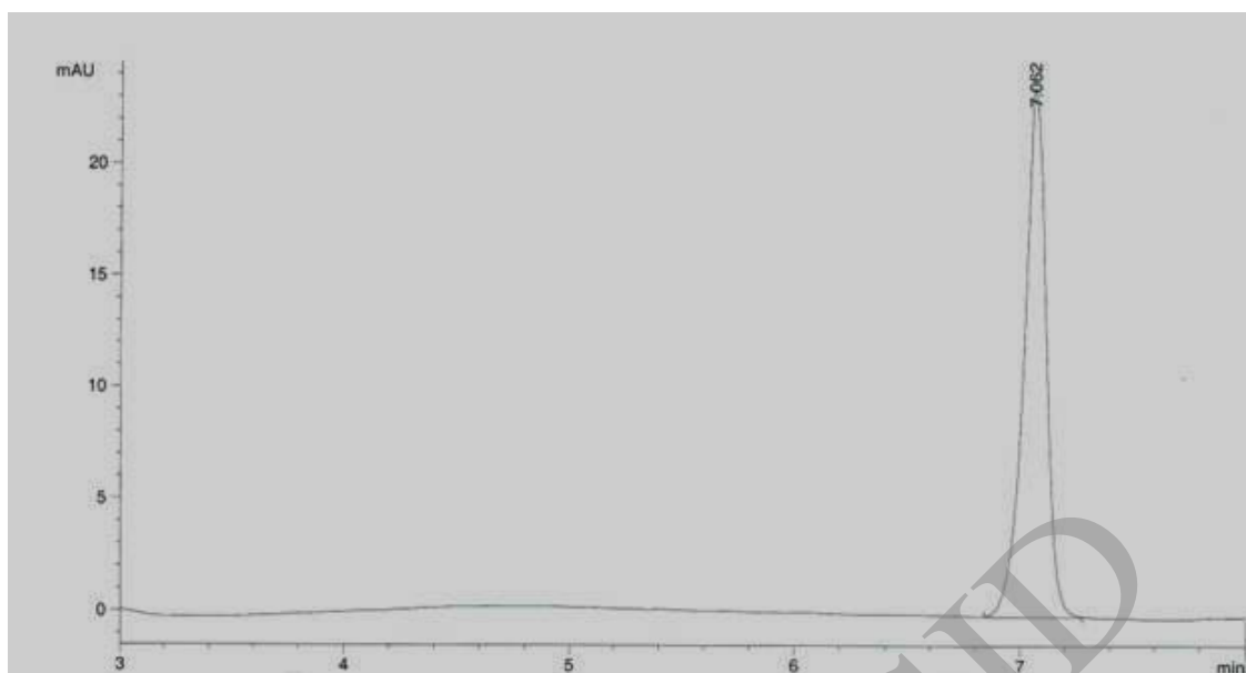
شکل ۲- کروماتوگرام مربوط به نمونه استاندارد سولفارافان. زمان نگهداری نمونه در ستون هفت دقیقه پس از تزریق می‌باشد.
