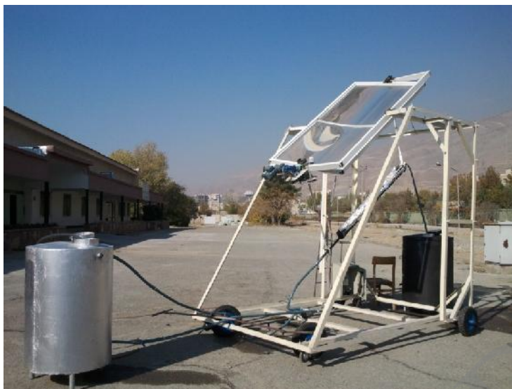
شکل ۲. متمرکزکننده خورشیدی با عدسی فرسنل خطی
