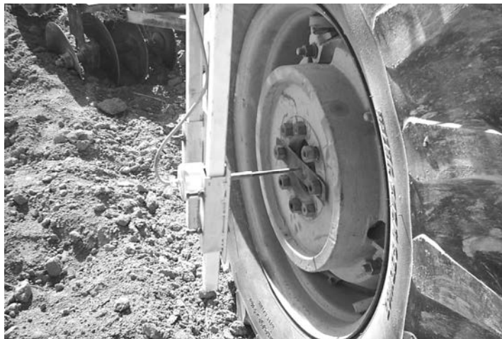
شکل ۲ - دستگاه دریابه نوع انکودر کوپله شده به محور چرخ تراکتور
