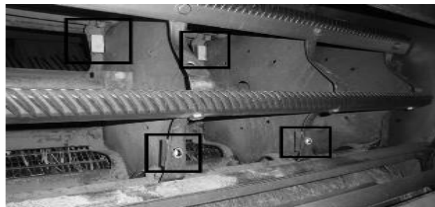
شکل (۱۵) موقعیت نصب میله‌ها روی کوبنده
