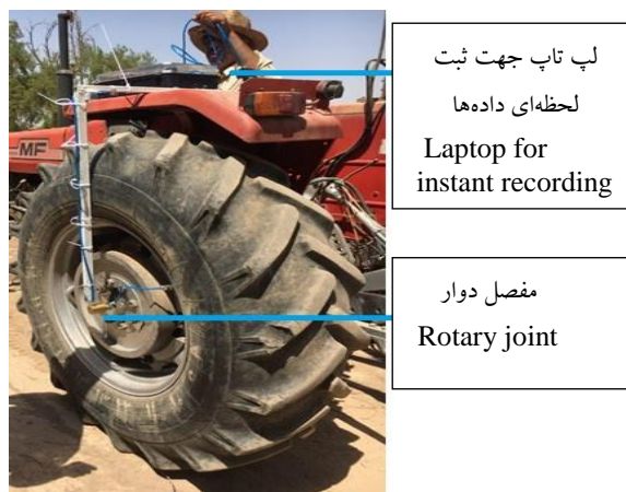
شکل (۳) مفصل دوار و محل نصب آن روی تایر تراکتور مسی فرگوسن ۲۸۵ Figure (3) Rotary joint and its installation position on the tractor tire of Massey Ferguson 285
