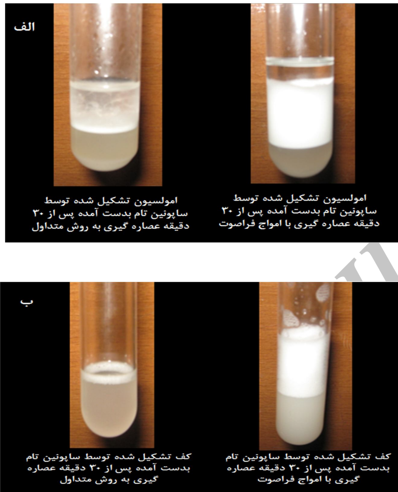
شکل ۲- مقایسه وضعیت تشکیل امولسیون (الف) و تشکیل کف (ب) توسط ساپونین تام بدست آمده پس از ۳۰ دقیقه عصاره-گیری به روش متداول و با امواج فراصوت
