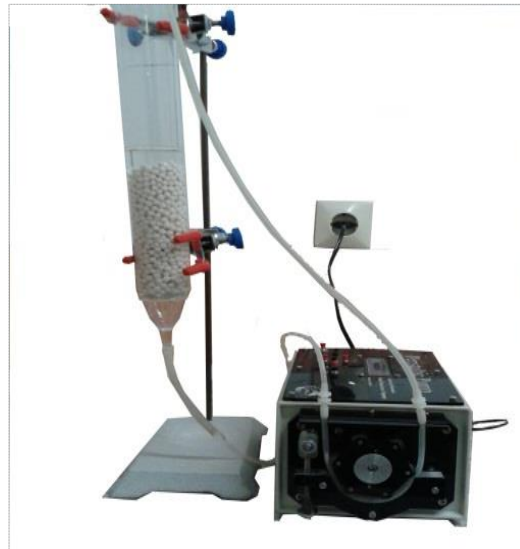
شکل ۲ - پمپ پرستالتیک و ستون شیشه‌ای حاوی آلومین با مخمر تثبیت شده
