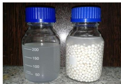
شکل ۱ - سوسپانسیون میکروبی سمت چپ تصویر و آلومین با سوسپانسیون سلولی سمت راست تصویر
