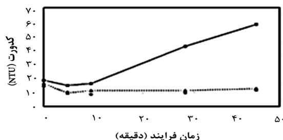
آزمایش 7- زمان پالس 5 ثانیه و شدت جریان الکتریکی 0/03 آمپر آزمایش 8- زمان پالس 5 ثانیه و شدت جریان الکتریکی 0/1 آمپر آزمایش 9- زمان پالس 5 ثانیه و شدت جریان الکتریکی 0/5 آمپر
