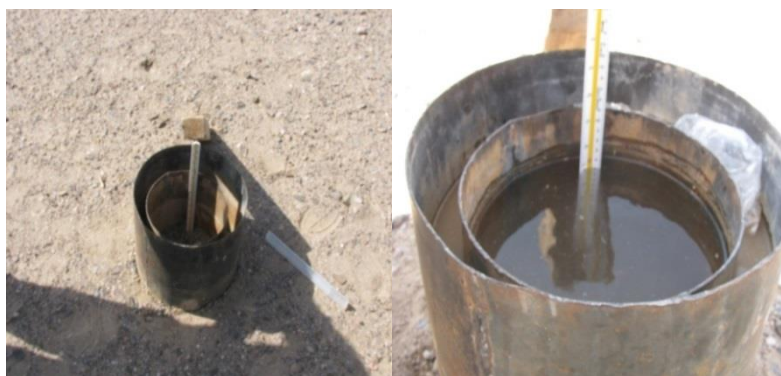
شکل ۲- اندازه‌گیری نفوذپذیری به روش استوانه مضاعف در منطقه
