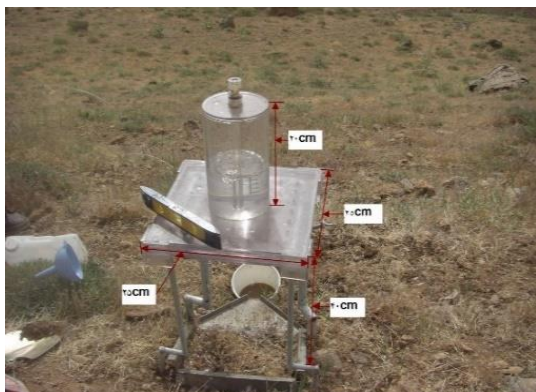
شکل ۵- دستگاه شبیه‌ساز باران و ابعاد آن در واحد کاری صحرائی
