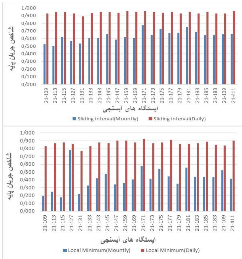
شکل ۴- تغییرات میانگین سالیانه شاخص جریان پایه مستخرج از داده‌های روزانه و ماهانه به روش‌های مختلف در ایستگاه‌های مورد پژوهش
