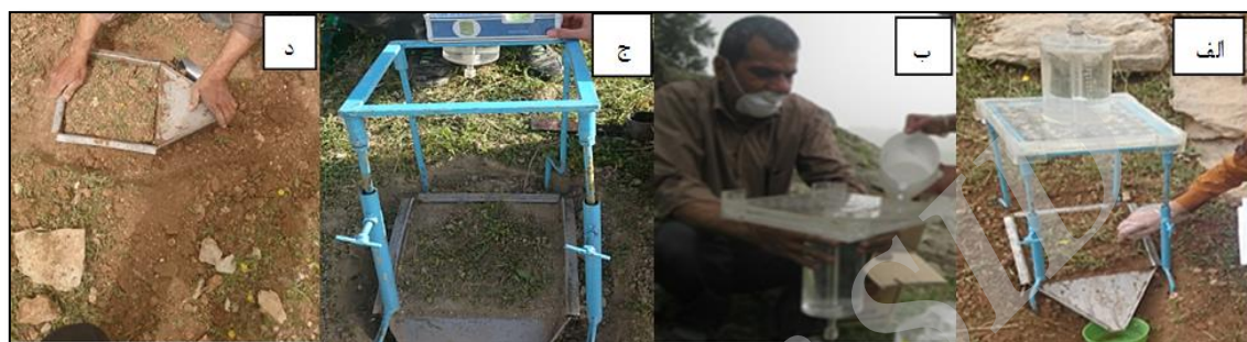
شکل ۲- الف) نحوه نمونه‌برداری، ب) پر کردن مخزن، ج) تراز کردن دستگاه، د) پلات دستگاه بارانساز
