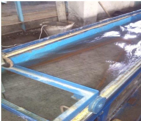
شکل ۱۸- تصویر اثر تداخل جریان و استغراق در H/P=0.83 و D=6\text{ cm} و P=6\text{ cm} ، L/W=4 با ضریب دبی 0.34 و دبی Q=27\text{lit/s}
