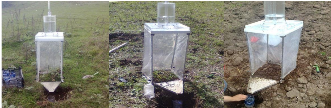
شکل ۲- شبیه‌سازی بارش در سه کاربری به ترتیب از راست به چپ: زمین زراعی، مرتع با ۵۰ و مرتع با ۱۰۰ درصد پوشش
