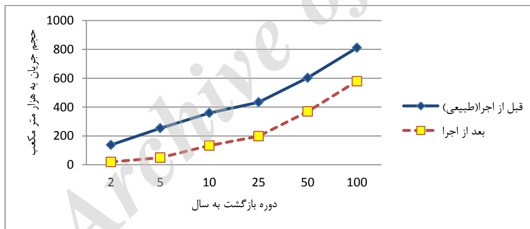
شکل ۱۳- مقایسه نتایج مدل هیدرولوژیکی در شرایط قبل و بعد از اجرای عملیات آبخیزداری
