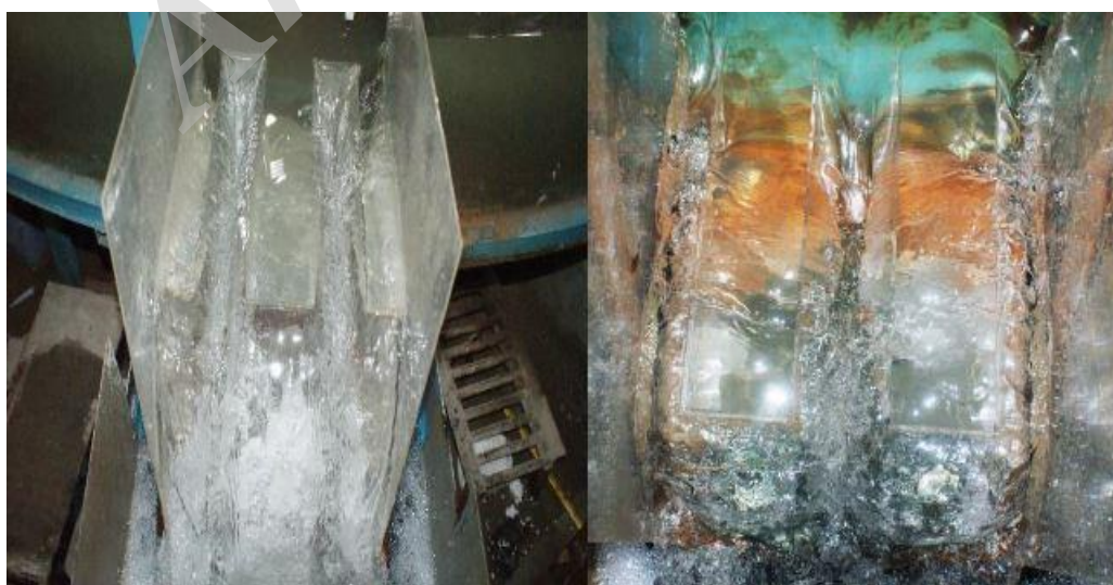
شکل ۳- نمایی از سرریزهای کلیدپیانویی تیپ B و C و تغییرات پروفیل سطح آب
