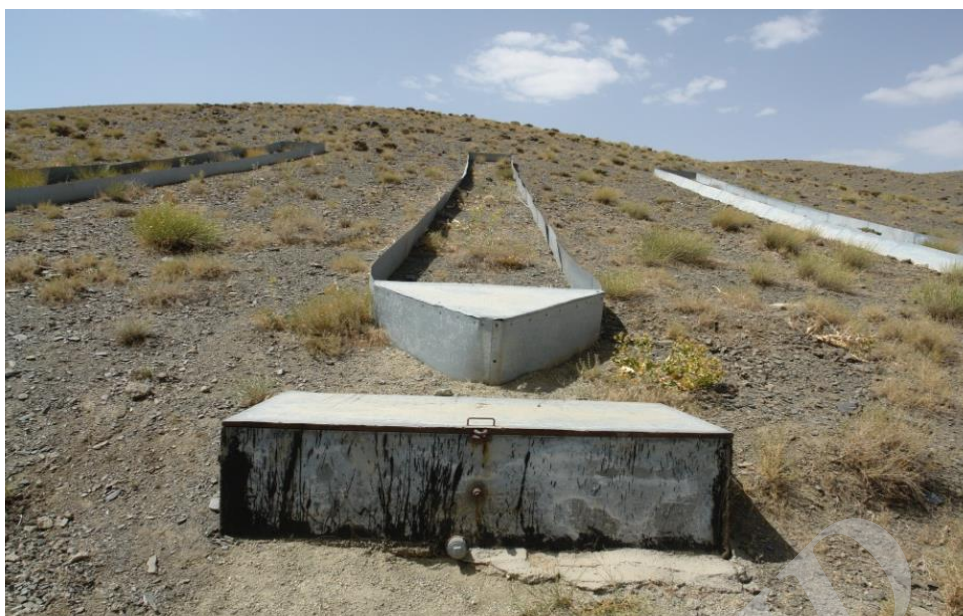
شکل ۳- کرت‌های آزمایشی و مخازن جمع‌آوری رواناب محتوی رسوب
